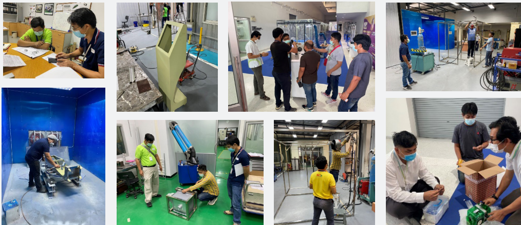
รูปที่ 6 การดำเนินการจัดสร้างและประกอบต้นแบบ ห้องแยกโรคความดันลบ
