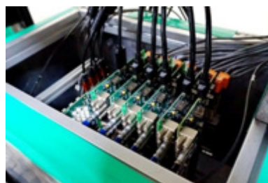
รูปที่ 13 เซเนอร์รอนพร้อมบอร์ดอิเล็กทรอนิกส์สำหรับอ่านข้อมูลติดตั้งอยู่ในกล่องที่ทำจากตะกั่ว
