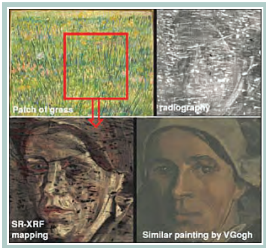
ตัวอย่างภาพที่ตรวจสอบโดยเทคนิค X-ray Fluorescence หรือ XRF ทำให้เห็นภาพก่อนหน้า
