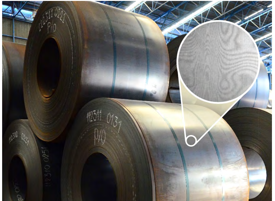
ลักษณะลายไม้ที่เกิดบนแผ่นเหล็ก
