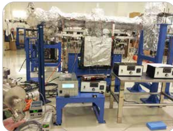
รูปที่ 53 แสดงการอบไล่ความชื้นและทดสอบระบบสุญญากาศก่อนการติดตั้งในวงกักเก็บอิเล็กตรอน
